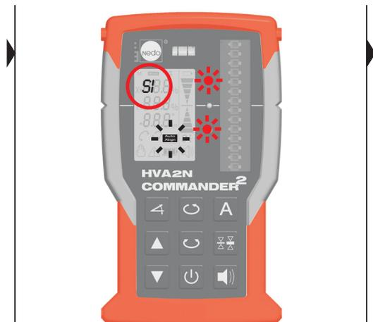
I LED e il simbolo AUTOALIGN lampeggiano durante la ricerca. Sul display del COMMANDER 2 HVA2N viene visualizzato >> SI <<
