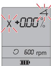
На дисплее мигает знак оси X и значение её наклона.
