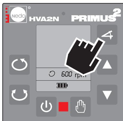
Вызовите, как обычно, функцию наклона: измеренный ранее наклон оси Y был автоматически сохранён в функции наклона, и его теперь можно снова вызвать.
