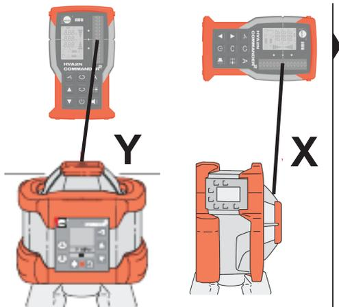
Zaměřte COMMANDER 2 HVA2N na PRIMUS 2 HVA2N; horizontálně: Y, vertikálně: X.
