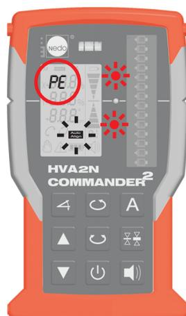
Diody LED oraz symbol AUTOALIGN pulsują podczas wyszukiwania. Na wyświetlaczu COMMANDER 2 HVA2N wyświetlany jest symbol >> PE <<.
