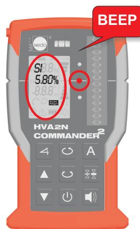
Поиск заканчивается, когда лазерный луч попадает на нулевую метку приёмника. Оба мигающих светодиода гаснут, знак AUTOALIGN горит постоянно. COMMANDER 2 HVA2N издаёт звуковой сигнал и показывает наклон в %.
