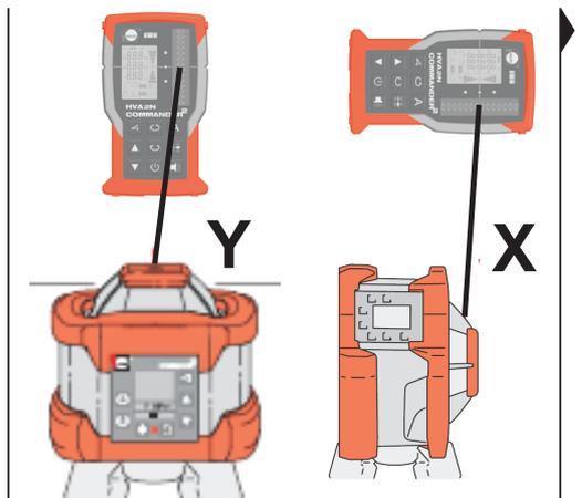
Zaměřte COMMANDER 2 HVA2N na PRIMUS 2 HVA2N; horizontálně: Y, vertikálně: X
