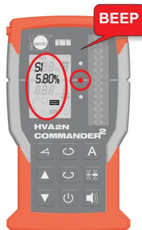
Wyszukiwanie kończy się z chwilą, gdy promień laserowy padnie na znacznik zerowy odbiornika. Obie pulsujące diody LED gasną, symbol AUTOALIGN świeci się ciągle. Urządzenie COMMANDER 2 HVA2N generuje sygnał akustyczny i wskazuje obliczone pochylenie w wartościach procentowych.
