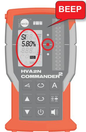
Alla fine di AUTOALIGN single viene visualizzata sul display l'inclinazione dell'asse Y (qui: 5,80%)
