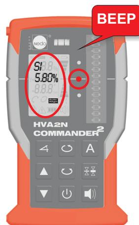
La ricerca termina quando il raggio laser colpisce la tacca zero del ricevitore. I due LED lampeggianti si spengono, il simbolo AUTOALIGN si accende a luce continua. Il COMMANDER 2 HVA2N genera un bip e visualizza l'inclinazione rilevata in valori percentuali
