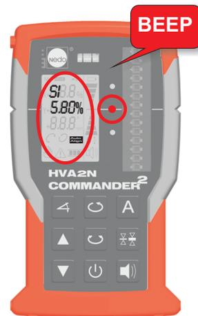
Po zakończeniu pomiaru AUTOALIGN na wyświetlaczu pokazane zostanie pochylenie osi Y (tutaj: 5,80%).
