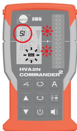
Diody LED oraz symbol AUTOALIGN pulsują podczas wyszukiwania. Na wyświetlaczu COMMANDER 2 HVA2N wyświetlany jest symbol >> SI <<.
