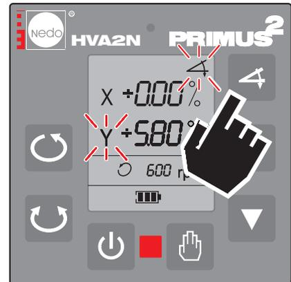
Premere 2 volte il tasto **4**: sul display appare l'inclinazione dell'asse Y rilevata in precedenza con AUTOALIGN single (5,80%)
