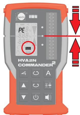
Urządzenie COMMANDER 2 HVA2N przez cały czas kontroluje położenie promienia laserowego i w przypadku odchylenia kieruje go z powrotem na znacznik zerowy urządzenia COMMANDER 2 HVA2N.
