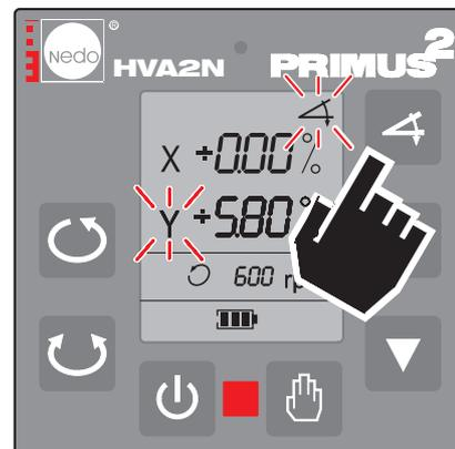
Нажмите 2 раза кнопку
