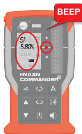
Proces vyhledávání se ukončí, když laserový paprsek najde nulovou značku přijímače. Obě blikající kontrolky LED zhasnou, symbol AUTOALIGN trvale svítí. COMMANDER 2 HVA2N vydá zvukový signál a ukáže zjištěný sklon v %
