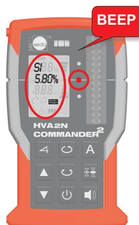
Søgningen afsluttes, når laserstrålen har ramt modtagerens nulmærke. De to blinkende LED'er slukker, symbolet AUTOALIGN lyser vedvarende. COMMANDER 2 HVA2N udsender et bip og viser den målte hældning i %-værdier
