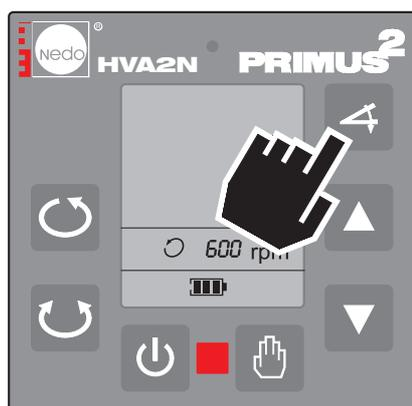
Vyvolejte funkci sklonu jako obvykle: předchozí naměřený sklon osy Y se automaticky převzal do funkce sklonu a lze jej zde opět vyvolat.
